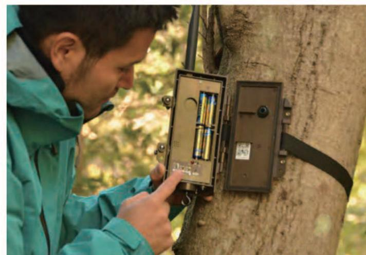
▲子機モードの場合は電池稼働。付属ベルトで固定するだけなので設置も簡単。
