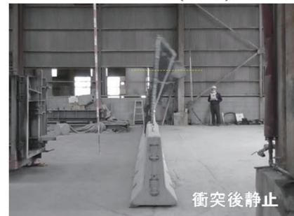
重錘衝突後の最大変形(側面)
